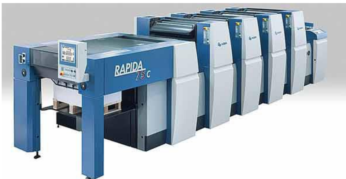
Slika 12. Mašina KBA Rapida 75 4/0 za tabačnu ofset štampu (KBA, nd)
