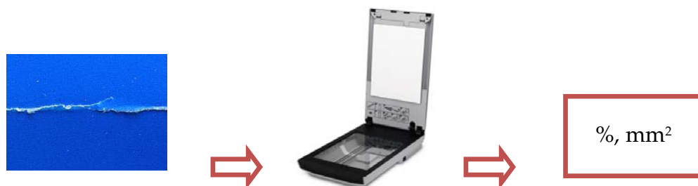
Slika 2.14 – Šematski prikaz toka određivanja količine oštećenja površine premaza papira
