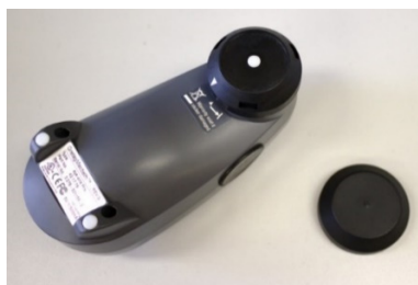
Slika 5.18. Izgled mernog uređaja sa dodatkom difuzera i poklopca za kalibraciju
