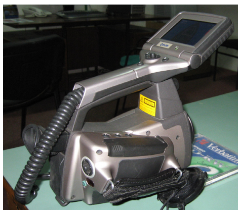
Slika 7.13.1. Termovizijska kamera FLIR - tip P65
