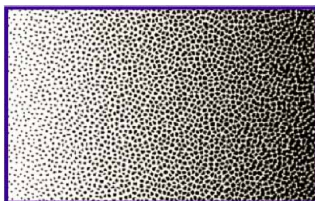
Slika 7. Hibridni raster koji stohastički raspoređuje AM rasterske tačke
