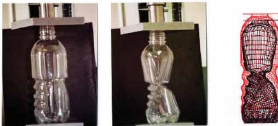
Slika 3: Prikaz realnog testa opterećenja i simuliranog testa
