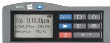
Slika 7.8: Uređaj za merenje površinske hrapavosti TR200 - Time Group Inc, China (RP Electronics, 2017)
