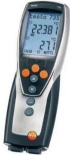
Slika 7.21: Testo 735-2 – Višekanalni termometar (Testo Limited, 2018)
