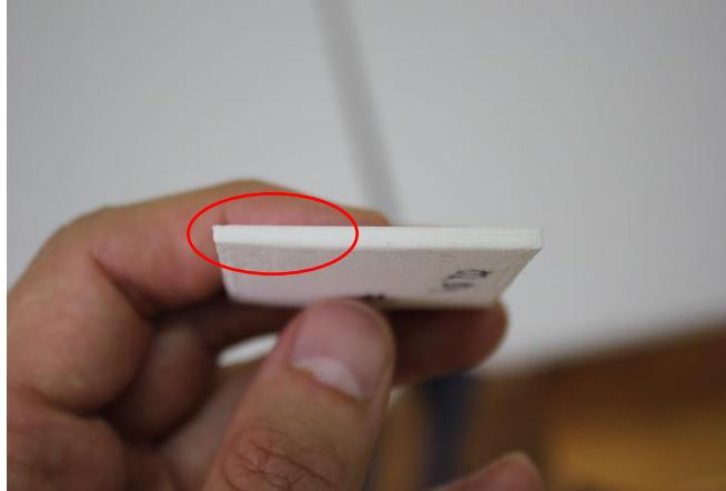
*Slika 9.2: Deformacija u donjem delu alata za utiskivanje izrađenog FDM tehnikom 3D štampe – mogući uzrok neujednačene visine utisnutih elemenata*
