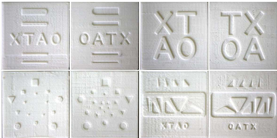
*Slika 7.49: Komplet alata izrađenih FDM tehnikom 3D štampe*
