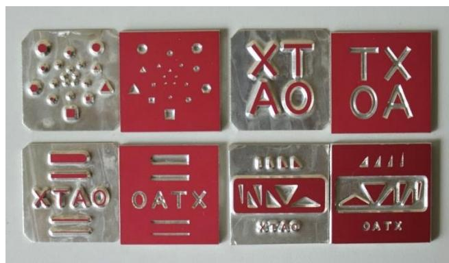
*Slika 7.35: Komplet alata izrađenih tehnikom hemijskog nagrizanja magnezijuma namenjenih za istraživanje obuhvaćeno doktorskom disertacijom*
