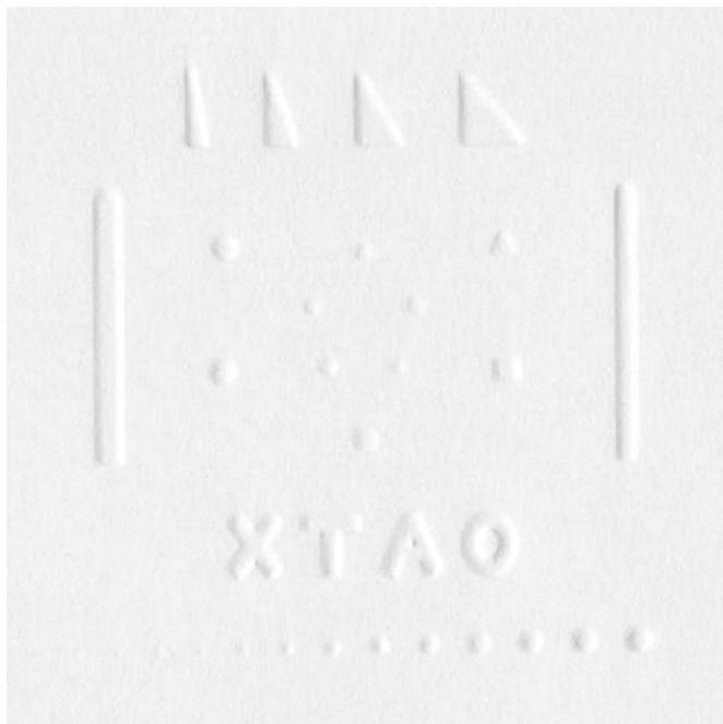
Slika 9.3: Prikaz skeniranog uzorka papira utisnutog alatom izrađenim SLA tehnikom 3D štampe
