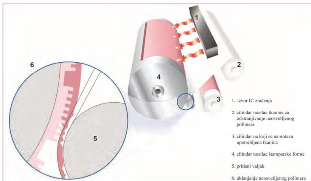
*Slika 2.7: Šematski prikaz principa termalnog razvijanja digitalne (CtP) fleksne štamparske forme*
