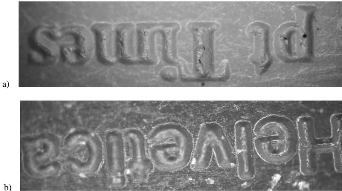
*Slika 4.30: Mikroskopski snimak tekstualnog elementa (negativ) na štampaskoj formi A; uvećanje 100x: a) serifni font veličine 1 pt b) bezserifni font veličine 1 pt*
