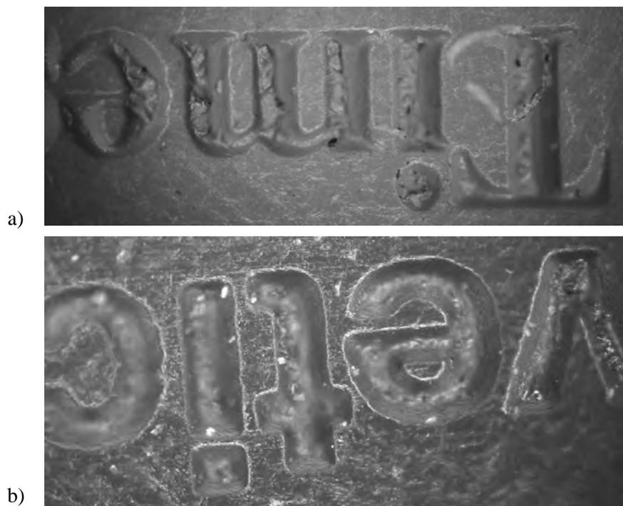
Slika 4.31: Mikroskopski snimak tekstualnog elementa (negativ) na štampaskoj formi A; uvećanje 100x: a) serifni font veličine 2 pt b) bezserifni font veličine 2 pt
