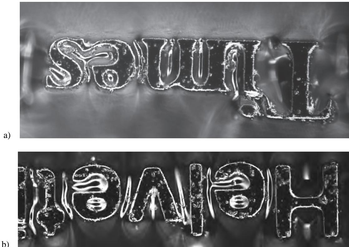
*Slika 4.39: Mikroskopski snimak tekstualnog elementa (pozitiv) na štampaskoj formi B; uvećanje 100x: a) serifni font veličine 1 pt b) bezserifni font veličine 1 pt*
