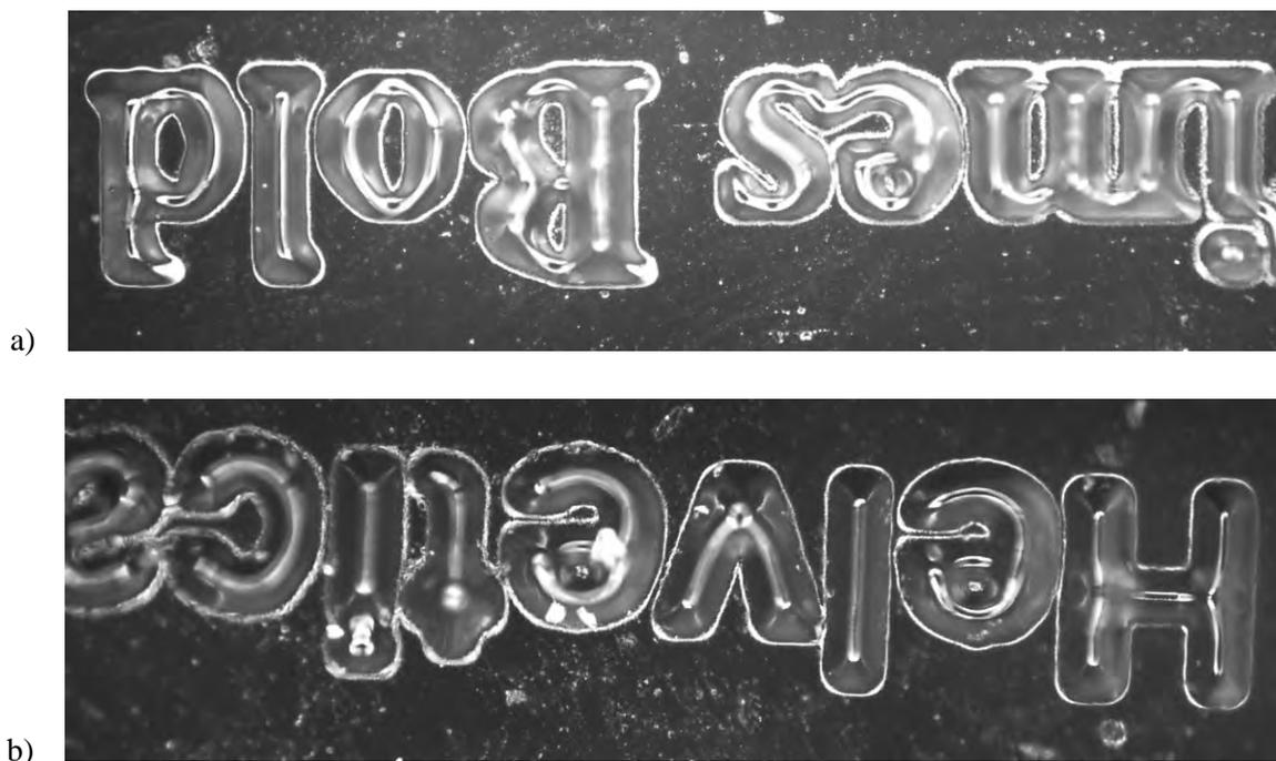
*Slika 4.42: Mikroskopski snimak tekstualnog elementa (negativ) na štampaskoj formi B; uvećanje 100x: a) serifni font veličine 1 pt b) bezserifni font veličine 1 pt*
