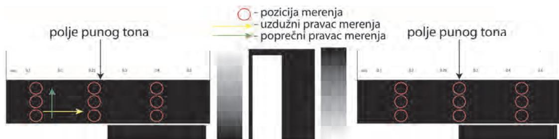
Slika 3.16: Šematski prikaz pozicija merenja površinske hrapavosti na štamparskim formama A (procesirane sa različitim vrednostima vremena glavnog osvetljavanja i razvijanja)
