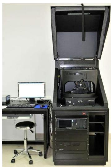
**Slika 5.20.** Izgled korišćenog Nano Indenter Agilent G200 uređaja za nanoindentaciju
