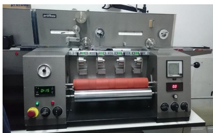
**Slika 5.4.** Izgled Prüfbau uređaja za test štampu u laboratorijskim uslovima
