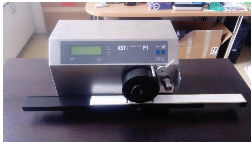
Slika 5.12. Izgled IGT F1 Basic High uređaja za oplemenjivanje otiska
