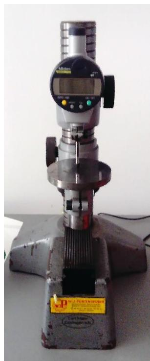
**Slika 5.6.** Izgled korišćenog uređaja za merenje debljine uzorka
