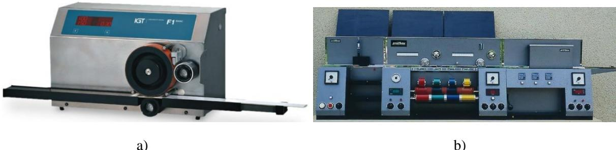
**Slika 2.9.** Izgled laboratorijskih uređaja test štampu: a) IGT F1 (IGT Testing Systems, 2018),
