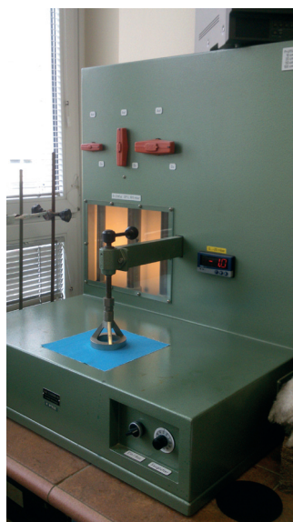
Slika 6.7. Mjerni uređaj za mjerenje vazdušne propustljivosti
