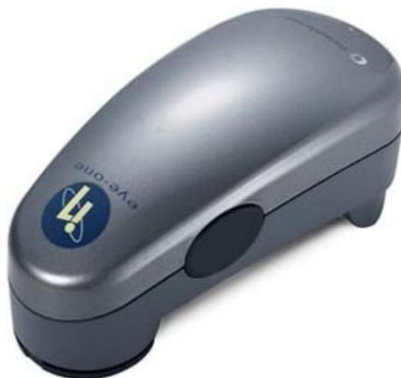
Slika 8.8. Merni uređaj spektrometar X-rite i1 pro
