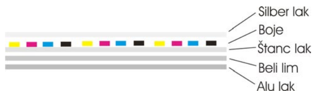
Slika. 3. Šema slojeva koji se nanose na beli lim
