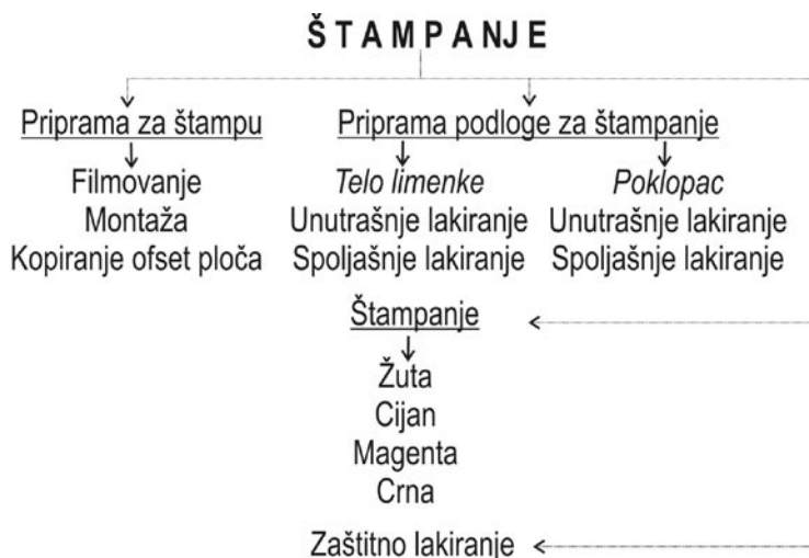
Slika. 1. Proces štampanja duboko vučene konzervne limenke
