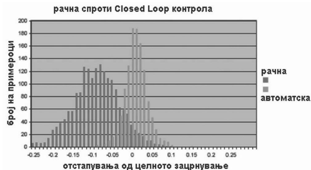
Slika 10. Ručna nasuprot automatske Closed Loop kontrole
