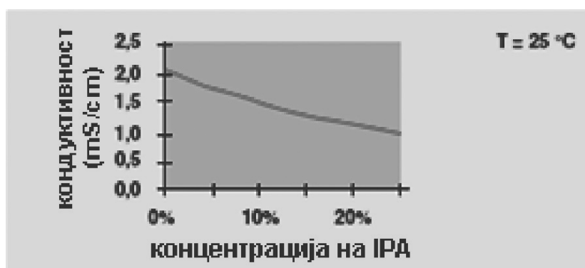
Slika 1. Zavisnost sprovodljivosti od koncentracije IPA
