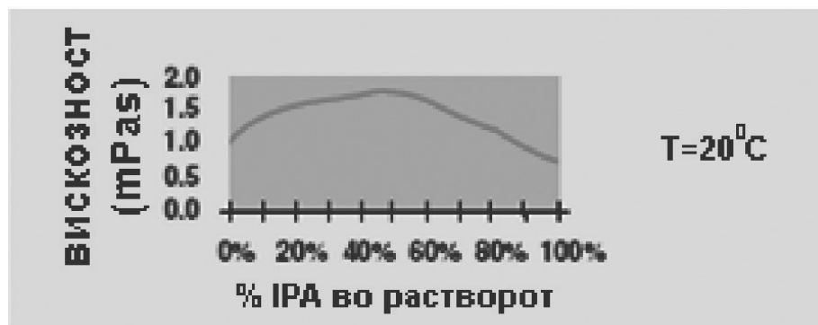
Slika 6. Zavisnost viskoziteta od koncentracije IPA u rastvorima za vlaženje pri 20°C
