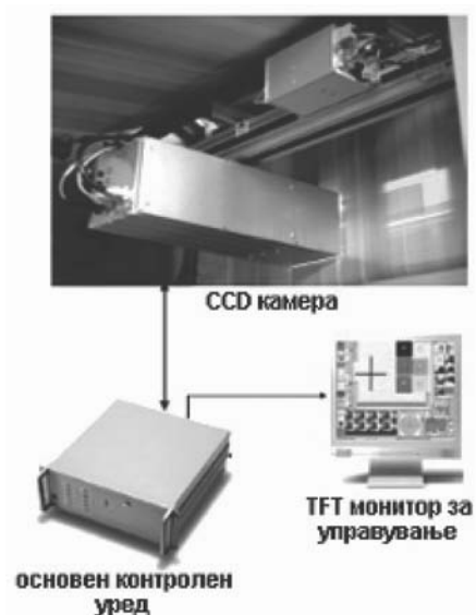
Slika 7. Instalirana CCD kamera na mašini za štampu novina
